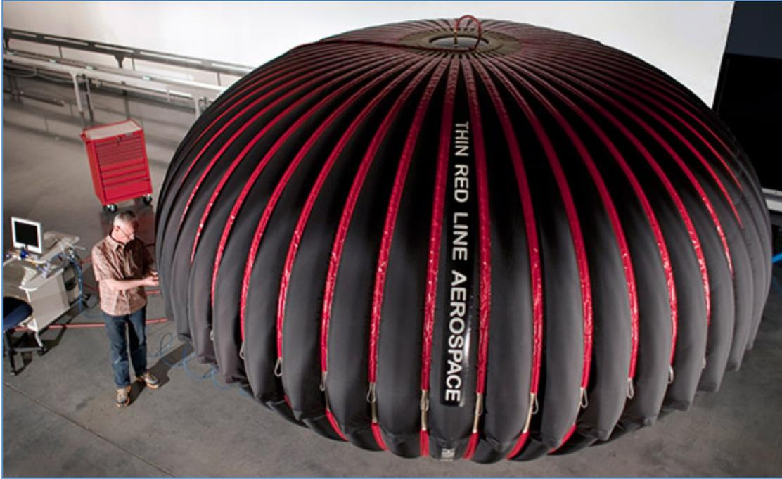
**Figure 22. Démonstrateur de ballon pour stockage d'air comprimé sous-marin présenté début 2011 par Thin Red Line**
