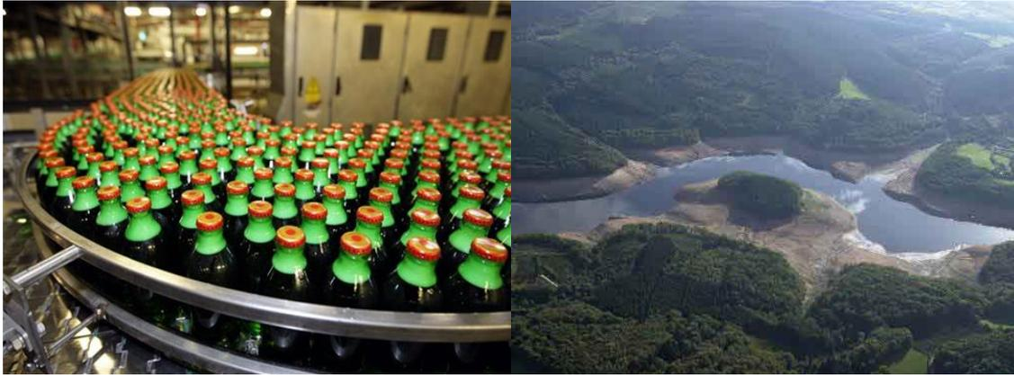
**Figure 16.** A gauche : stock tampon sur une chaîne d'embouteillage, permettant de faire face à un aléa en amont ou en aval du stock sans arrêter le reste de la ligne.
